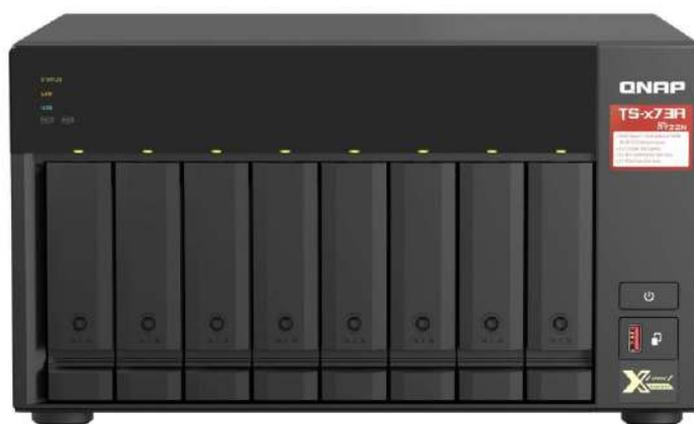
Il NAS è un dispositivo hardware autonomo, simile ad un piccolo server esso contiene più dischi rigidi (HDD) per un totale di 64 Terabyte per memorizzare i dati. E' dotato di una porta di rete Ethernet che consente di collegarlo alla rete locale. Questa connessione di rete è ciò che consente agli utenti e ai dispositivi di accedere ai dati memorizzati sul NAS.
