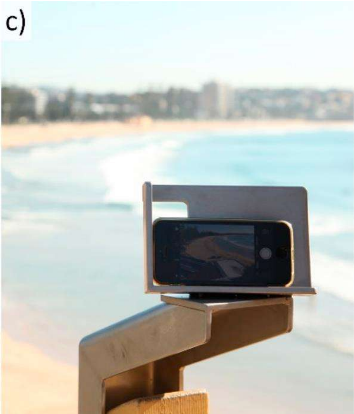
Figura 9 - Tipologia di stazione "C" - Supporto per smartphone installato su recinzione in legno già esistente, in questo caso il banner sul funzionamento del sistema CoastSNAP, su supporto rigido, può essere impernato alla recinzione in legno
