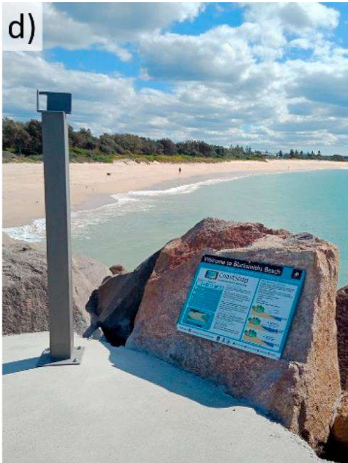
Figura 10 - Tipologia di stazione "D" - Supporto per smartphone installato paletto metallico, impernato su una esistente pavimentazione, in questo caso il banner sul funzionamento del sistema CoastSNAP, su supporto rigido, è stato impernato su uno scoglio presente nell'area di posizionamento alla radice di una diga frangiflutti di un porto
