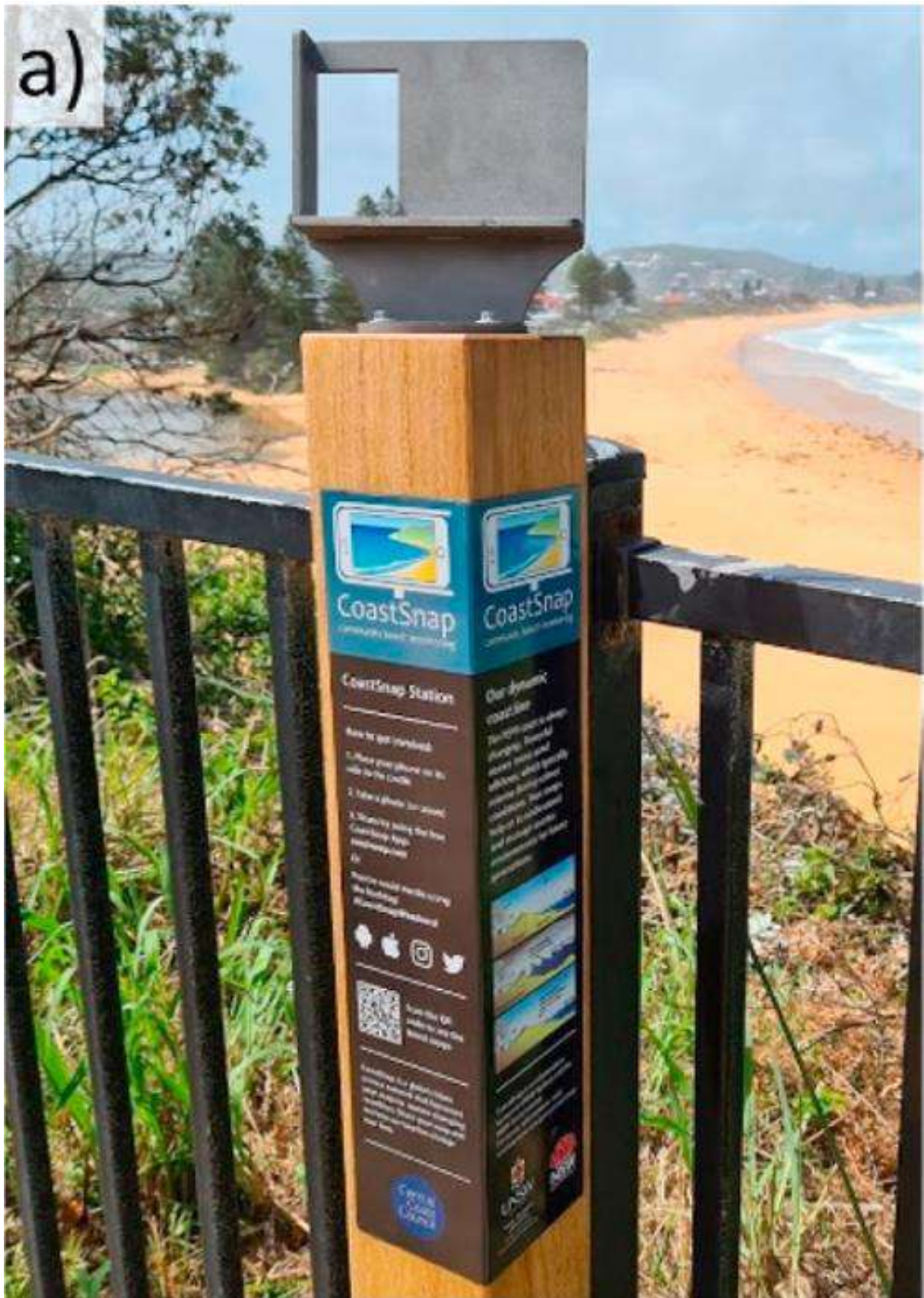
Figura 7 - Tipologia di stazione "A" - Supporto per smartphone installato su un paletto in legno, con annesso banner sul funzionamento del sistema CoastSNAP
