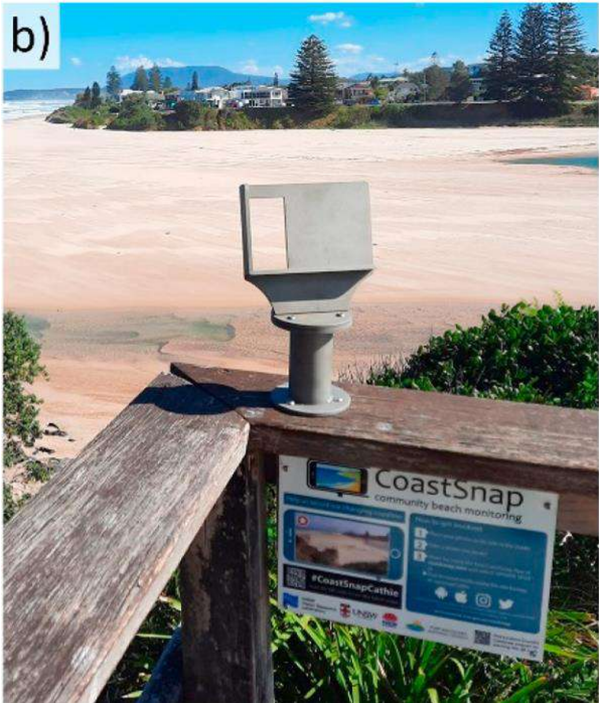
Figura 8 - Tipologia di stazione "B" - Supporto per smartphone installato su parapetto in legno già esistente, in questo caso il banner sul funzionamento del sistema CoastSNAP, su supporto rigido, può essere impernato alla parapetto in legno
